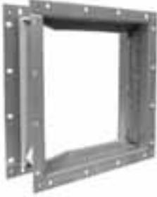
Соединительный патрубок с эластичной проставкой для компенсации колебаний и прерывания передачи корпусного шума при подсоединении вентилятора к другим узлам системы. Состоит из двух фланцев и эластичной проставки.
