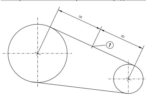
Другой простой метод регулировки и контроля натяжения осуществляется по статической частоте приводного ремня. Для этого плоскому или клиновому ремню ударами придаются колебания. Эти колебания замеряются электронным измерительным прибором. Ремень нужно натянуть так, чтобы эти колебания в Гц соответствовали заданным значениям (см. документацию / заводскую табличку).
