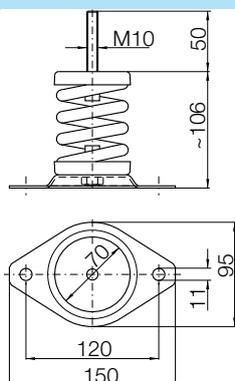
Амортизаторы препятствуют передаче вибрации и корпусного шума на фундамент.
