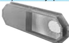
Защитный кожух ремня в стандартном исполнении изготавливается из оцинкованного стального листа и закрыт со всех сторон (по DIN EN 294-1). Для осмотров и проверок ремня переднюю часть можно отсоединить и снять.
